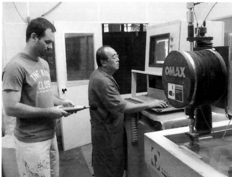
Figura 42 - Medição do nível de pressão sonora para a máquina de corte com jato de água de alta pressão
