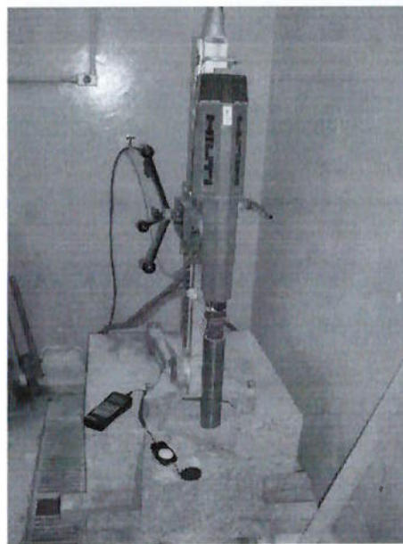
Figura 28 - Medição do iluminamento na máquina de extração de corpos de prova
