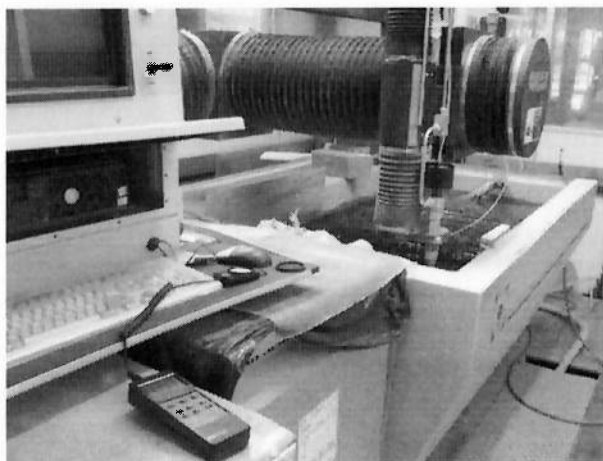
Figura 22 - Medição do iluminamento na máquina de corte com jato de água de alta pressão
