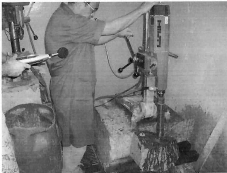
Figura 32 - Medição do nível de pressão sonora para a máquina de extração de corpos de prova
