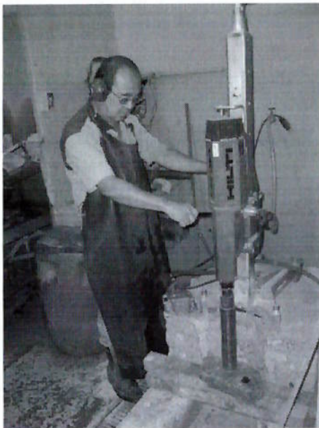
Figura 48 - Dosimetria de ruído na operação da máquina de extração de corpos de prova
